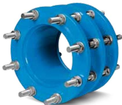
Оснащенная тремя жесткими фланцами демонтажная вставка UNIJOINT PAS20 является отличным решением для всех стандартных областей применения. Регулировка длины на  $\pm 20$  мм или  $\pm 25$  мм (в зависимости от номинального диаметра) позволяет легко осуществить монтаж и демонтаж оборудования. Демонтажная вставка UNIJOINT PAS20 оснащена соединительными фланцами одинаковых размеров с обеих сторон и жестко фиксируется на трубопроводе.
