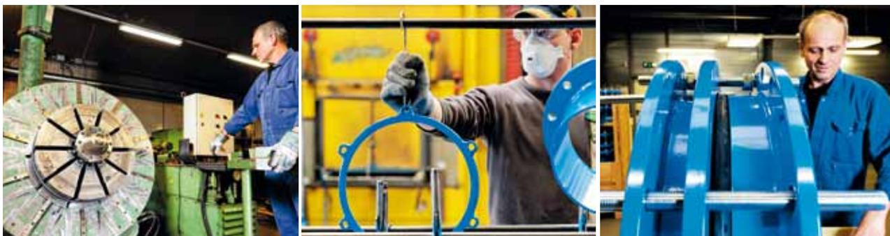
*Расширитель обеспечивает абсолютно круглую форму изделия, поверхность которого защищена высококачественным эпоксидным покрытием. Заключительными этапами являются сборка и контроль качества.*
