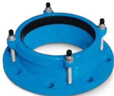
Фланцевый адаптер UNIJOINT является наиболее простым элементом монтажной арматуры. С одной стороны он оборудован фланцевым соединением любого требуемого стандарта, а с другой стороны – раструбом для соединения с гладким концом трубы. Фланец может быть смонтирован на любой стандартный тип труб, в том числе на обрезанных концах труб без специальной обработки.
