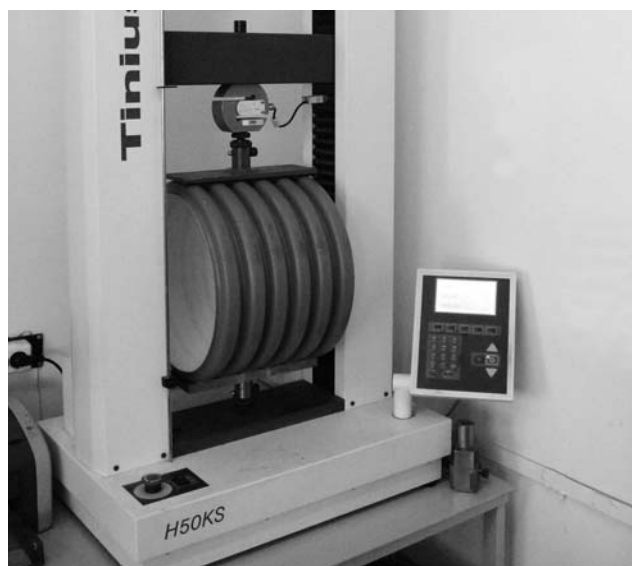
Фото 3.1. Лаборатория ИКАПЛАСТ: испытание ПП гофрированной трубы на кольцевую жесткость
