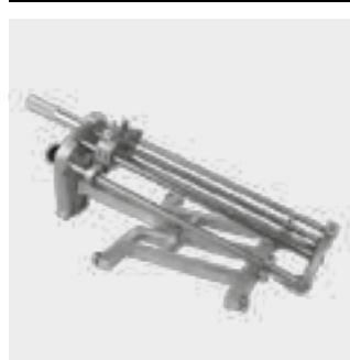
Ротационное устройство для надежного снятия оксидного слоя с труб из ПЭ-НД на половину длины или на полную длину муфты. Износостойчивый твердосплавный резец для обеспечения длительного срока службы. Равномерное снятие стружки посредством подпружиненного резца и автоматической подачи. Запасной резец и аэрозоль-смазка для ухода за инструментом прилагаются.
