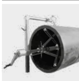
Для надежного снятия оксидного слоя на трубах большого диаметра из ПЭ-НД d 800-d 1200 в диапазоне SDR 11 - SDR 33. Модульная конструкция для простого обращения и быстрого монтажа. Быстрый подбор соответствующего диаметра. Находящийся по центру привод управляет приводной рукояткой. Автоматическая компенсация овальности трубы и допусков посредством подпружиненного резца и автоматической подачи. Поворотный резец имеет две режущие поверхности (двойной срок службы).
