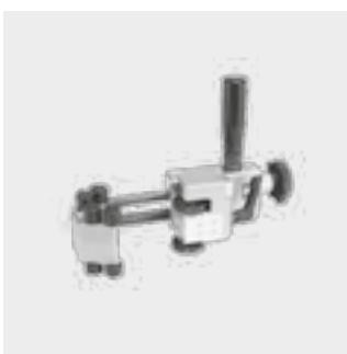
Ротационное устройство для надежного снятия оксидного слоя с труб из ПЭ-НД и РЕ-Ха. Износостойчивый твердосплавный резец для обеспечения длительного срока службы. Равномерное снятие стружки посредством подпружиненного резца и автоматической подачи. Запасной резец прилагается.
