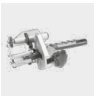
Ротационное устройство для надежного снятия оксидного слоя с труб из ПЭ-НД и РЕ-Ха. Износостойчивый твердосплавный резец для обеспечения длительного срока службы. Равномерное снятие стружки посредством подпружиненного резца и автоматической подачи. Запасной резец и FRIATEC аэрозоль-смазка для ухода за инструментом прилагаются.
