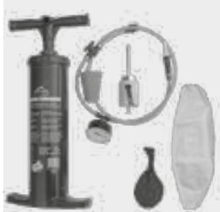
Ремонтный комплект для сдерживания остатков воды во время ремонтных и монтажных работ на водопроводах из ПЭ-НД d 90 - 900 мм. Состоит из универсального ремонтного набора (насос, манометр, сверло, соединительный шланг) и ремонтного воздушного баллона соответствующего диаметра.
