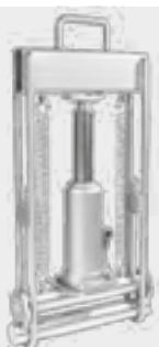
Гидравлический передавливатель для временного пережатия труб из ПЭ-НД и ПЭ-Ха d 63-d 180 SDR 11 и SDR 17,6.
