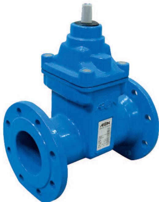
Уплотнение клина резиной NBR позволяет устанавливать задвижки на трубопроводах, транспортирующих канализационные и сточные воды (с включением твердых частиц). Запатентованная конструкция задвижки с обрезиненным клином NBR, с двойным уплотнением обеспечивает герметичность класса А на протяжении всего срока эксплуатации.
