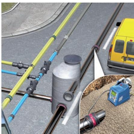
В течение многих лет полимерные трубопроводы использовались в газо- и водоснабжении. Сырье из полиэтилена высокой плотности привлекает незначительным весом изделий из него, устойчивостью к коррозии и агрессивной среде, а также превосходной свариваемостью. Для прокладки магистральных трубопроводов FRIALEN разработана программа электромужфтовой сварки для труб из полиэтилена диаметром от 75 до 225 мм.
