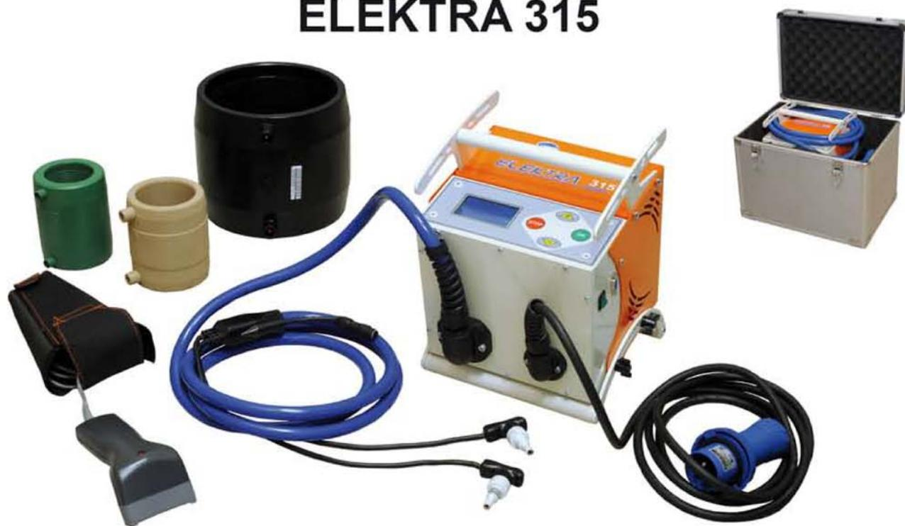
ELEKTRA 315 - это универсальный электромуфтовый аппарат для сварки электромуфт (ПЭ, ПП, напряжение сварки от 8 до 48 В) для транспортировки газа, воды и других жидкостей. Аппарат ELEKTRA 315 разработан в соответствии с итальянскими и международными стандартами. Машина поставляется в комплекте с оптическим сканером, с устройством ручного ввода и со встроенной системой протоколирования (память на 500 протоколов).
