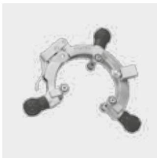
Устройство для надежного снятия оксидного слоя с концов труб из ПЭ-НД и РЕ-Ха одного конкретного диаметра, а также с поверхностей для посадки седлообразных фитингов. Поворотный резец имеет две режущие поверхности (двойной срок службы). Удобство посадки на трубу за счет открывающейся конструкции приспособления.
