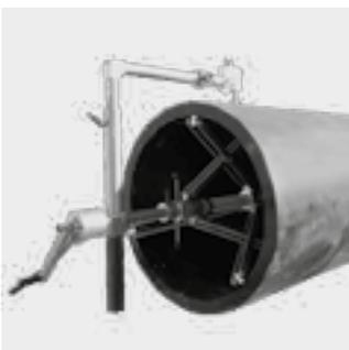
Для надежного снятия оксидного слоя на трубах большого диаметра из ПЭ-НД d 800-d 1200 в диапазоне SDR 11 - SDR 33. Модульная конструкция для простого обращения и быстрого монтажа. Быстрый подбор соответствующего диаметра. Находящийся по центру привод управляется приводной рукояткой. Автоматическая компенсация овальности трубы и допусков посредством подпружиненного резца и автоматической подачи. Поворотный резец имеет две режущие поверхности (двойной срок службы).
