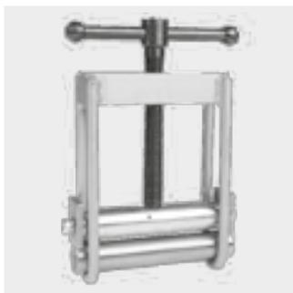
Ручной передавливатель для временного пережатия труб из ПЭ-НД и ПЭ-Ха d 63 - d 125 SDR11 и SDR 17,6.
