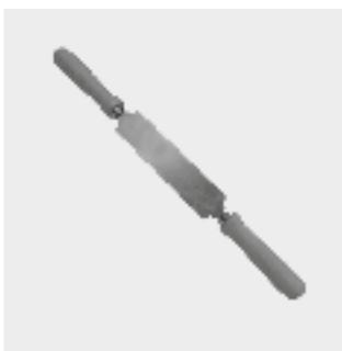
Предназначен для удаления оксидного слоя с труб ПЭ-НД больших диаметров, для обработки которых невозможно применить соответствующие зачистные устройства. Идеально подходит для подготовки поверхности перед монтажом седловидных фитингов FRIALEN XL. Также подходит для снятия фаски на концах труб.
