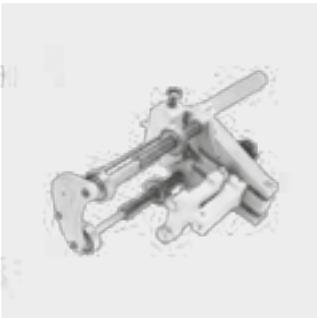
Ротационное устройство для надежного снятия оксидного слоя с патрубков фитингов без нагревательной спирали. Дополнительно возможно снятие оксидного слоя с труб из ПЭ-НД и РЕ-Ха (максимально на половину длины муфты d 710). Износоустойчивый твердосплавный резец для обеспечения длительного срока службы. Равномерное снятие стружки посредством подпружиненного резца и автоматической подачи. Запасной резец и аэрозоль-смазка для ухода за инструментом прилагаются.
