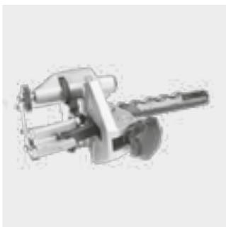
Ротационное устройство для надежного снятия оксидного слоя с труб из ПЭ-НД и РЕ-Ха. Износоустойчивый твердосплавный резец для обеспечения длительного срока службы. Равномерное снятие стружки посредством подпружиненного резца и автоматической подачи. Запасной резец и FRIATEC аэрозоль-смазка для ухода за инструментом прилагаются.
