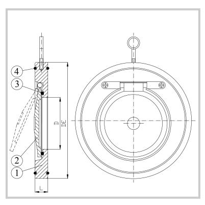
ВНЕШНИЙ ВИД:EN 1074-3ФЛАНЦЫ:EN1092-2ТЕСТЫ::EN 12266-1РАБОЧАЯ ТЕМПЕРАТУРА;Max + 120°CРАБОЧЕЕ ДАВЛЕНИЕ:Min 0,3 bar
