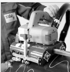
11 Повторите этот процесс со вторым концом трубы, обращая внимание на то, чтобы кольцевой зазор по обеим сторонам не был слишком большим (максимально 3 мм) и по периметру был одинаковым. Заклейте кольцевой зазор с двух сторон широкой клеящейся лентой.
