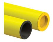
Наличие защитной оболочки у труб **ПРОТЕКТ 1075**, изготовленных из **ПЭ 100-RC**, позволяет применять их при прокладке трубопроводов газораспределительных сетей без устройства песчаного основания непосредственно на спланированное дно траншеи (кроме крупнообломочных грунтов) с обратной засыпкой местным грунтом без крупных включений, а также в узких траншеях.
